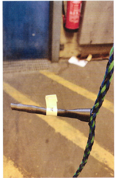
Kuva 1. Korkean hallin lämpötilajakauman selvittämiseksi opiskelijat rakensivat anturinauhat, jossa on kuvan mukaisia lämpötila-antureita 1 tai 2 m välein. Kuva: Teija Järvenpää.
